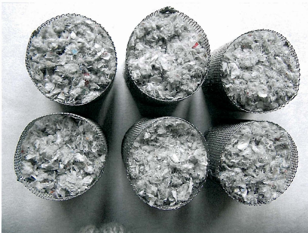
Fot. 1. Próbki materiału termoizolacyjnego EKO-FIBER po 4 tygodniowej inkubacji. Na żadnej z próbek nie stwierdzono wzrostu pleśni.
